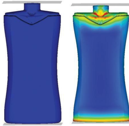
Instron 頂部載荷作用測試顯示 22g 瓶子的實際變形 頂部載荷作用模擬顯示 22g 瓶子的變形和壁厚 實際測試和模擬分析的應力和變形曲線比較
