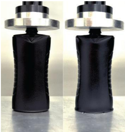
Instron 頂部載荷作用測試顯示 22g 瓶子的實際變形 頂部載荷作用模擬顯示 22g 瓶子的變形和壁厚 實際測試和模擬分析的應力和變形曲線比較
